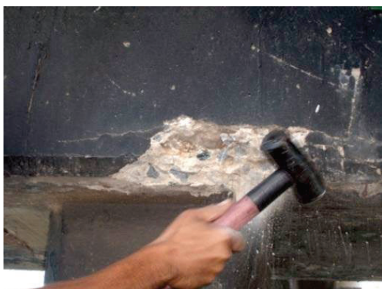
Figura 43 – Etapa de fratura do concreto em viga com fissura de corrosão (a) e trecho exposto da barra após ensaio de carbonatação, que mostrou que parte do concreto próximo à barra mantinha um pH elevado. Observou-se também a presença de precipitação de material gelatinoso de coloração esverdeada e de produtos de corrosão marrom e alaranjado no concreto da região (b).
