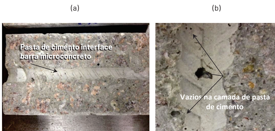
Figura 7 – Vista geral (a) e parcial (b) de corpo de prova fraturado na transversal e com remoção da barra de aço-carbono. Observa-se a presença da pasta de cimento na interface (a, b) e, também, de bolhas de ar e outros vazios de diferentes dimensões (b).
