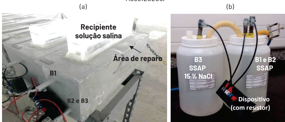
Figura 16 – Ensaio laboratorial de técnicas de recuperação utilizando corpos de prova de concreto armado (a) e de par galvânico aço-carbono/aço inoxidável em solução simulada de água de poro (SSAP)(b), ambos seguindo as diretrizes da ASTM A955:2020c.
