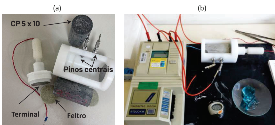
Figura 28 – Dispositivo e corpos de prova (a) e medida da resistência elétrica em curso com uso de terrômetro (b).
