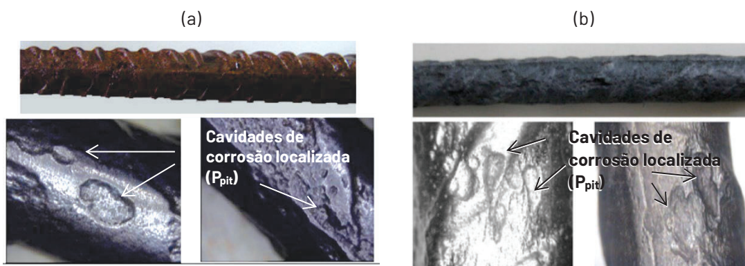
Figura 46 – Formação de cavidade de corrosão localizada ( P_{pit} ) pelo ataque de cloretos em barra de aço-carbono exposta diretamente à névoa salina (a) e inserida em concreto (b).
